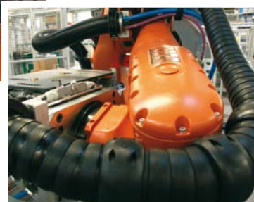
Das Einknicken der Achse 5 beim Ablegen erfordert eine äußerst flexible E-Kette®.
