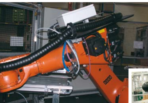
Das Einknicken der Achse 5 beim Ablegen erfordert eine äußerst flexible E-Kette®.
