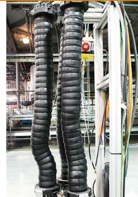
Triflex® R mit Chainflex® – Testaufbau im igus® Technikum in Köln.
