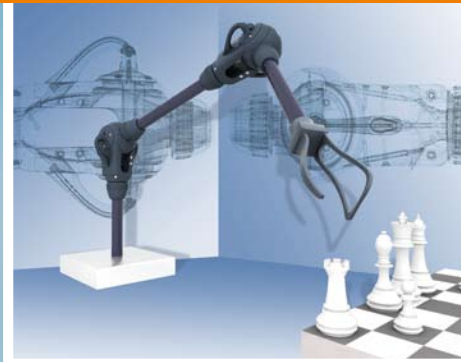
Einfach zusammenstecken: Antriebs-, Steuereinheit, Gelenkarme, Gelenke und Anbindungen.
