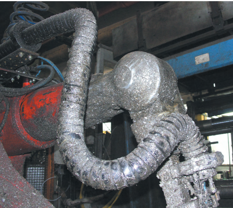
Robuste Energiezuführung mit Federstabmodulen in Magnesiumgießerei.
