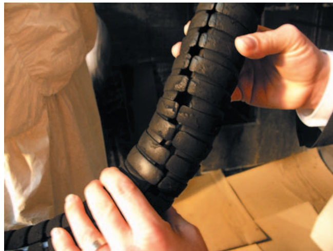
Energiezuführung für Lackierroboter (links). Einfach zu befüllen durch Eindrücken der Leitungen.
