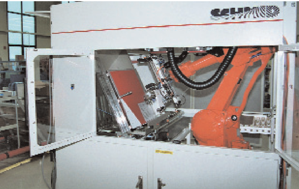
Die Triflex® R-Energiezuführung erlaubt die Ausführung komplexer Bewegungen in allen sechs Achsen.
