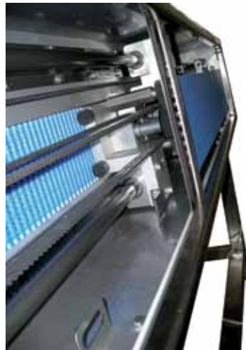
Politeco srl, marco Pertile, Vallese die Oppeano, Italy Antrieb für Entformermaschine Drive for demoulding machine
