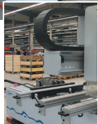
Vorkonfektionierte Energiezuführung für Bearbeitungszentrum.
