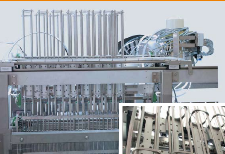
Automatische Becherzuführung für Abfüllanlage in der Molkerei-Industrie.
