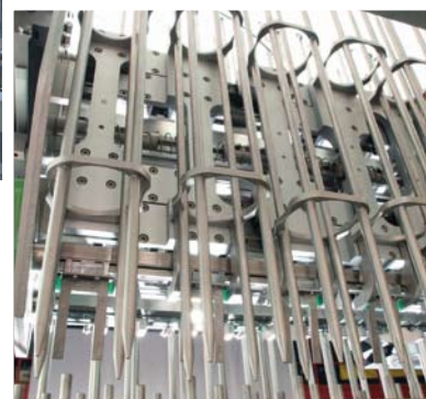
Automatische Becherzuführung für Abfüllanlage in der Molkerei-Industrie.
