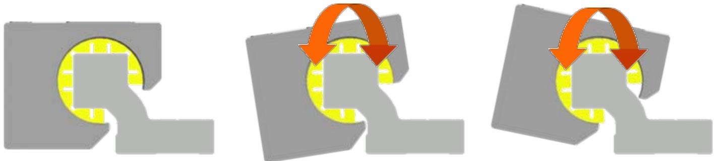
DryLin WQ: Typischer Anwendungsfall durchbiegender Montageplatte bei hoher Last
