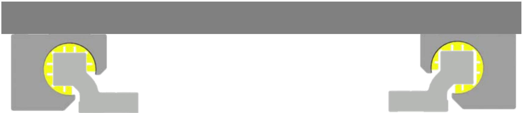
DryLin WQ: Typischer Anwendungsfall durchbiegender Montageplatte bei hoher Last
