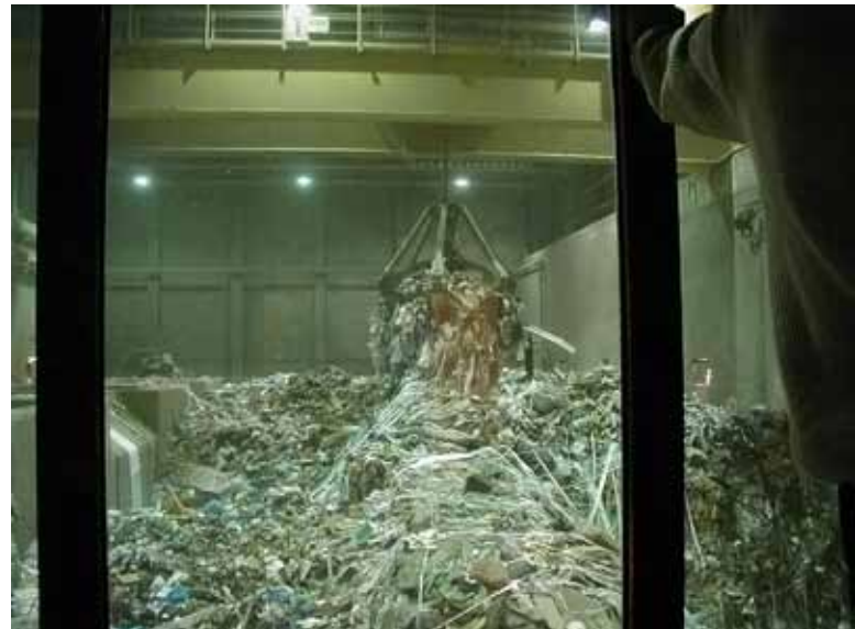
Bild FA2212-06: Müllverbrennungsanlage Weisweiler GmbH & Co. KG Aufnahme des Müllbunkers aus der Bedienkanzel. Staub, Schmutz und die Umgebungsbedingungen sind eine echte Herausforderung für alle Komponenten.
