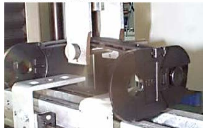
Ausreißversuch - E2/000 Öffnungsstege halten (hier 435 N)
