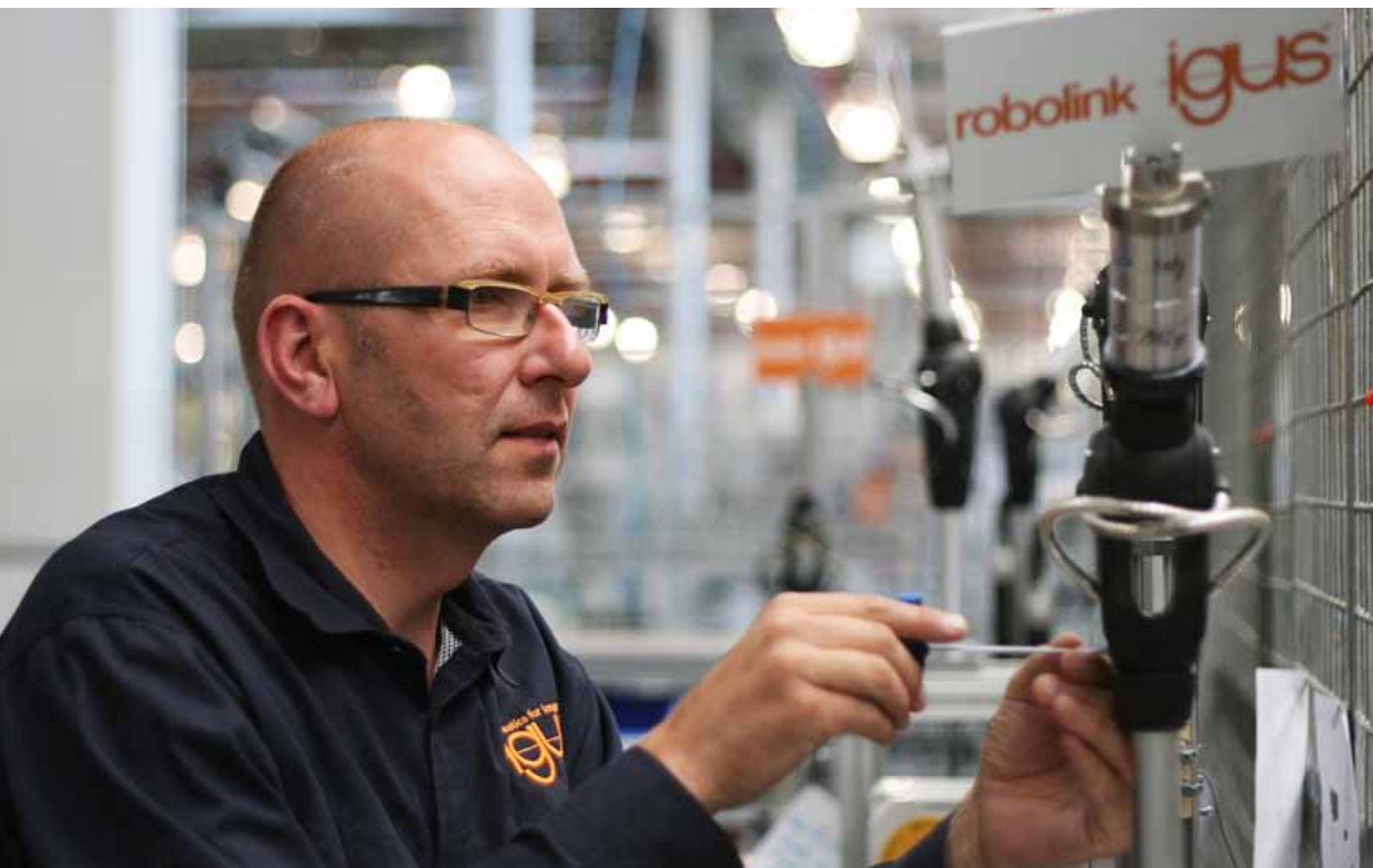
Sonderkonstruktion mit 4 DOF, 3 Gelenke in Reihe Fraunhofer IFF Magdeburg Special design with 4 DOF, 3 joints in series Fraunhofer IFF Magdeburg
