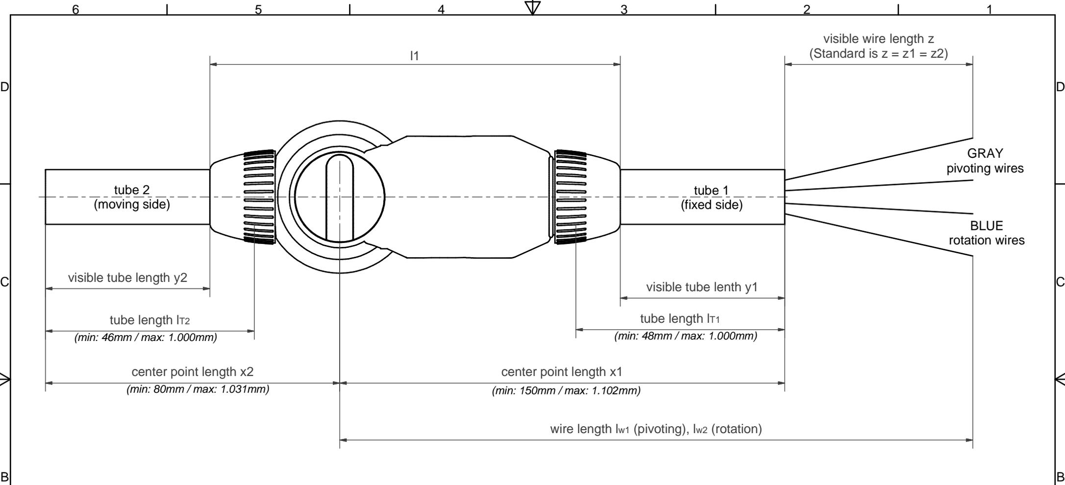
$$l_{T1} = x1 - 102\text{mm} = y1 + 33\text{mm}$$
