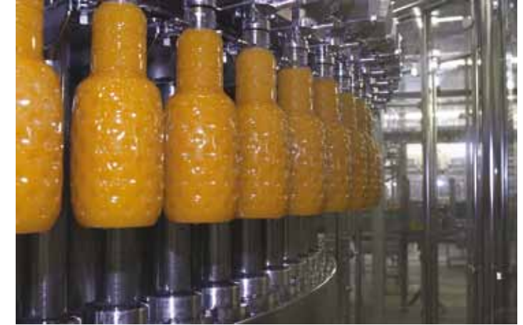
Pneumatisches Huborgan für aseptische Füllmaschinen - iglidur® überzeugt durch geringe Reibwerte bei Trockenlauf, Chemikalienbeständigkeit und niedrige Feuchtigkeitsaufnahme
