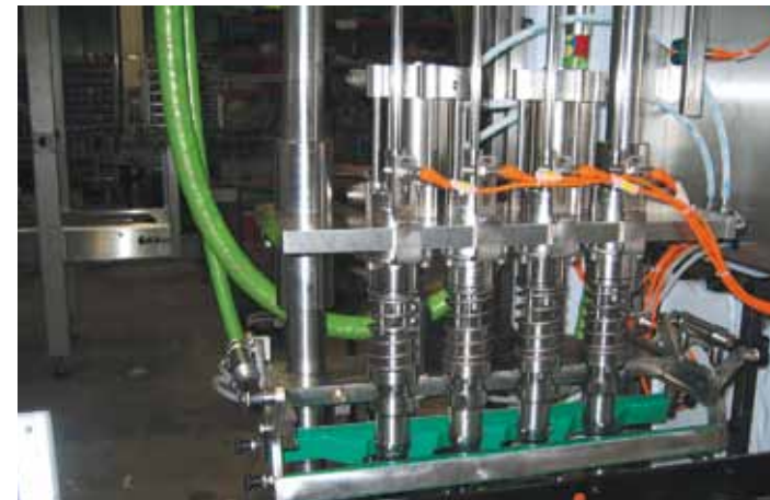
Kein Verschleiß nach 5 Jahren: iglidur®-Polymergleitlager und DryLin® R-Gleitfolien in einem Getränkedosenentleerer
