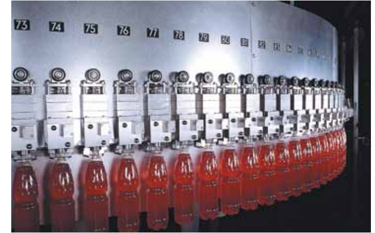
igidur® X in einem Füllventil zur Getränkeflaschenbefüllung
