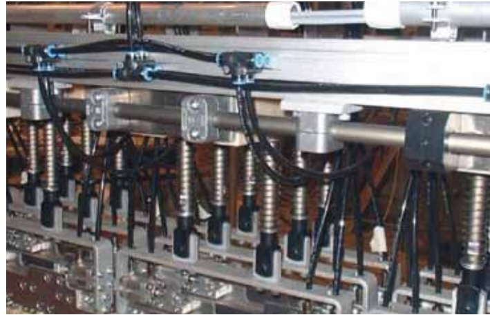
Flaschen-Packmaschine: Durch die Neuentwicklung eines Greifers mit igus® Führungselementen ist ein sehr schmales, robustes und schmiermittelfreies Greifwerkzeug entstanden, wie es derzeit nicht auf dem Markt erhältlich ist.
