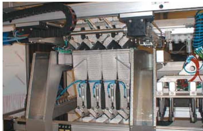
Schüttguthandling: Andrückvorrichtung mit Abstreiftechnik zum Verpressen von Schüttgut bei einem Verpackungsvorgang. Bei der Konstruktion wurden diverse igus®-Polymerlager verwendet.
