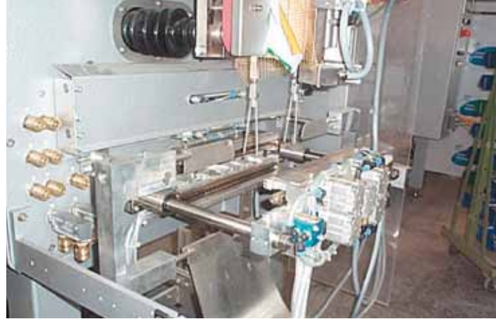
Bei Dauerbetrieb erreichen die Schweißbacken an Schlauchverpackungsmaschinen oftmals Temperaturen von 160 °C und mehr.
