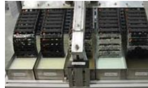
Medientest: Test der Haltbarkeit bei chemischen Beeinträchtigungen in der Bewegung Media test: Test of durability of chemical interferences in motion
