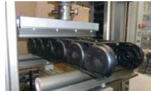
Bruchversuch: Ermittlung der max. freitragenden Länge break test: calculation of max. unsupported length
