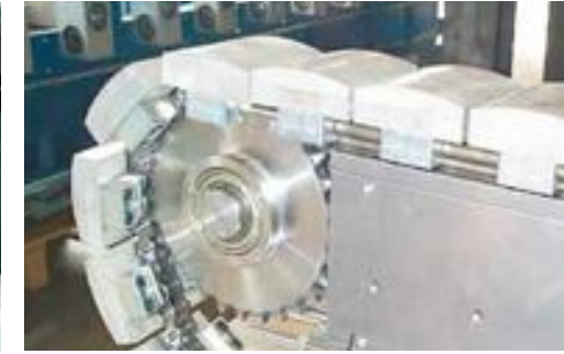
Förderkette für Güter mit empfindlichen Oberflächen mit drylin® W Chain for sensitive surfaces with drylin® W linear guide system
