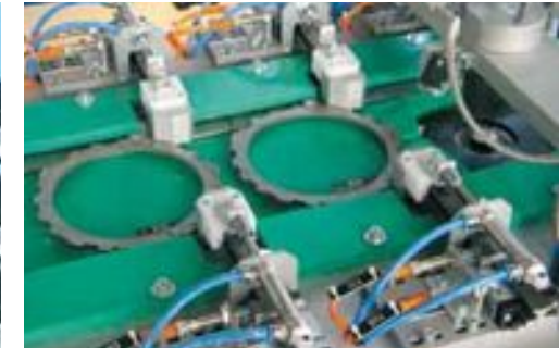
drylin®-Prüfstation für Wirbelstromrissprüfung in der Automobilindustrie drylin® test station for the eddy-current crack test of components for the automobile industry
