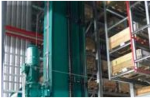
Mit igus® guidelok slimline „F“ sicher und günstig in die Höhe (hier 28 m) With cost-effective gus® guidelok slimline “F” safe vertical guiding (here: 28 m)
