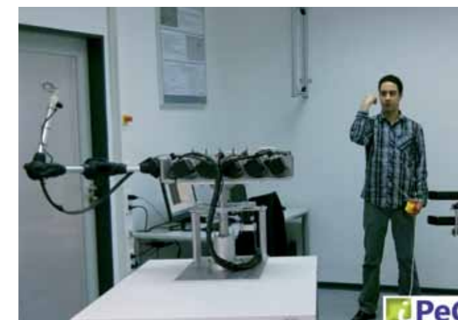
Die Leibnitz Universität Hannover, Institut für Produktentwicklung und Gerätebau; roboLink®-Gelenkarm mit Gestensteuerung. The Institute for Product Development and Machinery Design at the Leibnitz University, Hannover; roboLink-articulated arm with gesture based control.
