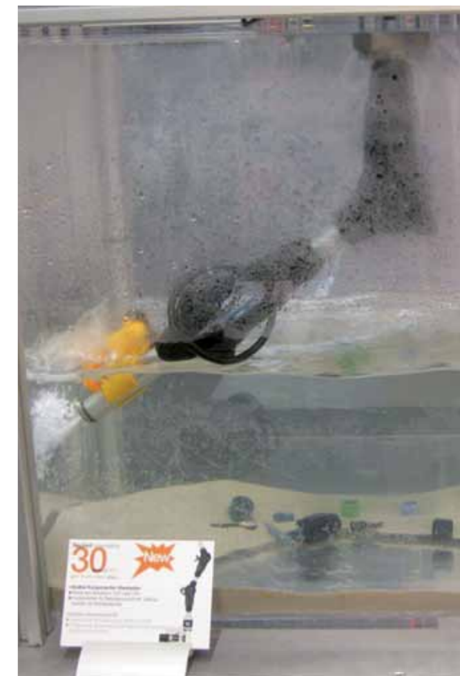
Unterwasser Kameraführung, Gelenkarm mit 4 DOF igus® Submerged camera guidance, articulated arm with 4 DOF, igus®
