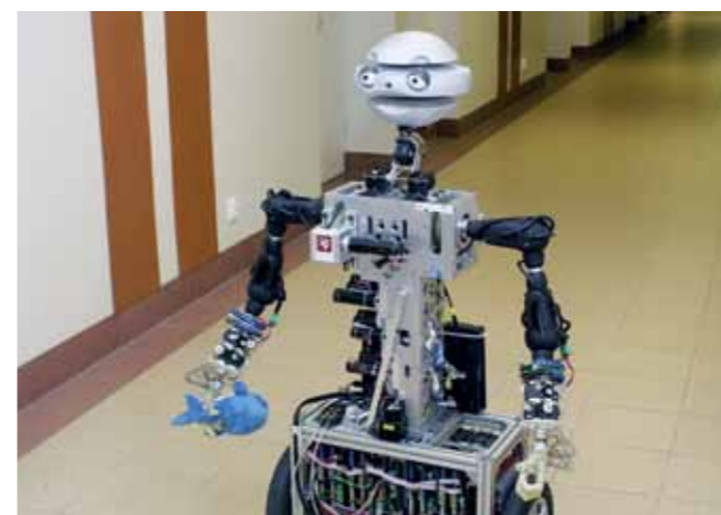
Die technische Universität Breslau in Polen hat Ihren autonomen Roboter FLASH mit 2 roboLink® Gelenkarmen mit je 4 Freiheitsgraden ausgestattet. The Technical University at Wroclaw, Poland equipped its autonomous robot Flash with 2 roboLink articulated arms, each with 4 DOF.
