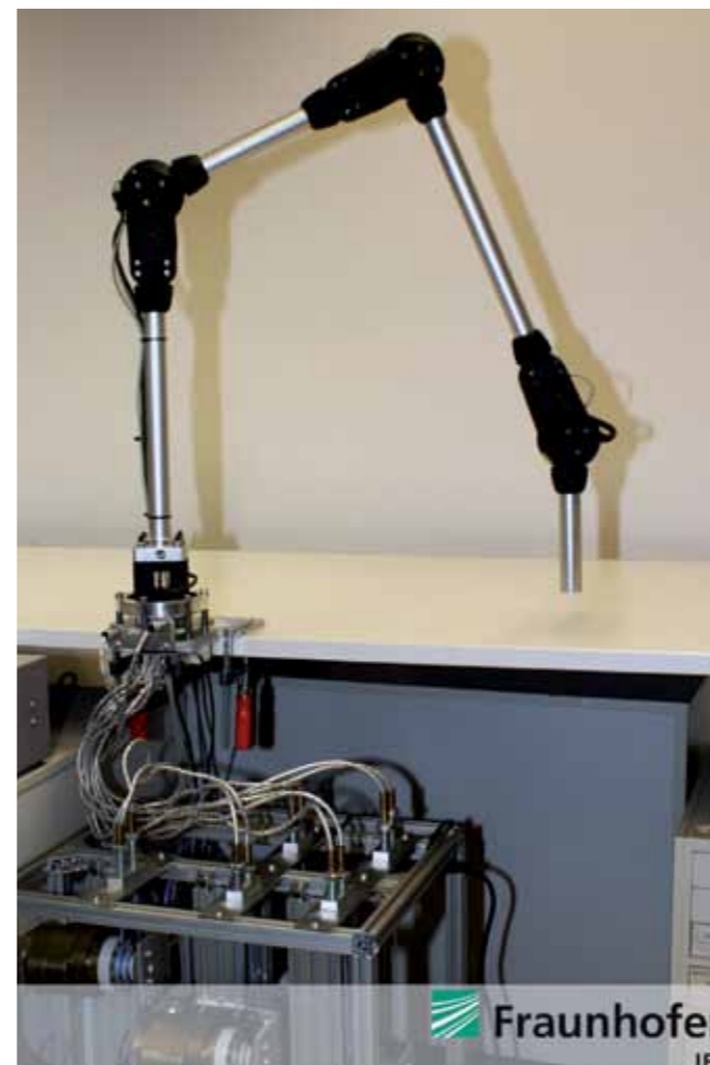
Sonderkonstruktion mit 4 DOF, 3 Gelenke in Reihe Fraunhofer IFF Magdeburg Special design with 4 DOF, 3 joints in series Fraunhofer IFF Magdeburg
