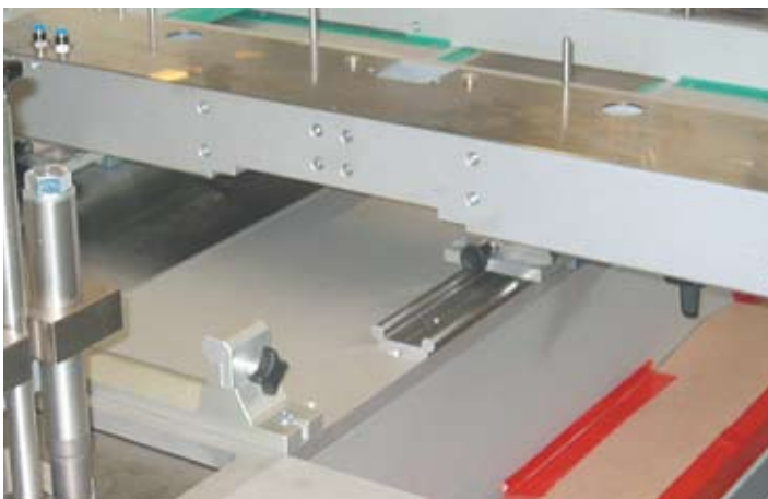
Die DryLin® W Lineargleitführung ist Reinraum-zertifiziert und deshalb geeignet für den Einsatz in dieser Blistermaschine.
