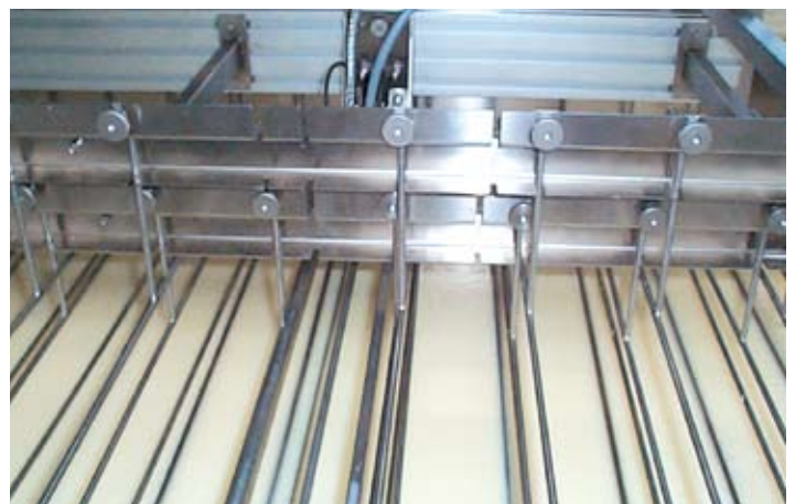
Schmiermittelfreie DryLin® T und DryLin® N in einer Back- und Transporteinheit
