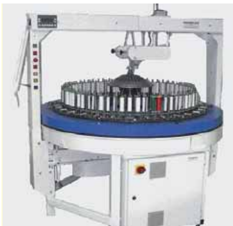
Oil-free: iglidur® G in lace-braiding machine Ölfrei: iglidur® G in Klöppelspitzenmaschine
