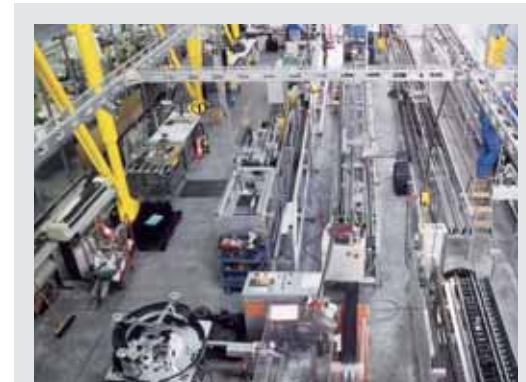
Chainflex® cables in life span test. Chainflex® Leitungen im Lebenslauf-Test.
