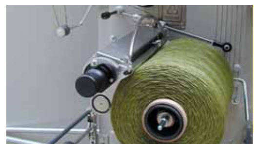
igubal® rod end bearing in thread guide unit igubal® Gelenklager in Fadenführeinheit
