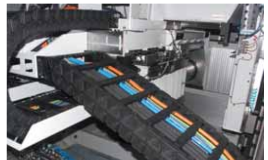
E-Chain® with Chainflex® cables E-Kette® mit Chainflex®-Leitungen
