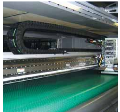
Low vibration: E6 in large-format printer Vibrationsarm: E6 in Großformatdrucker
