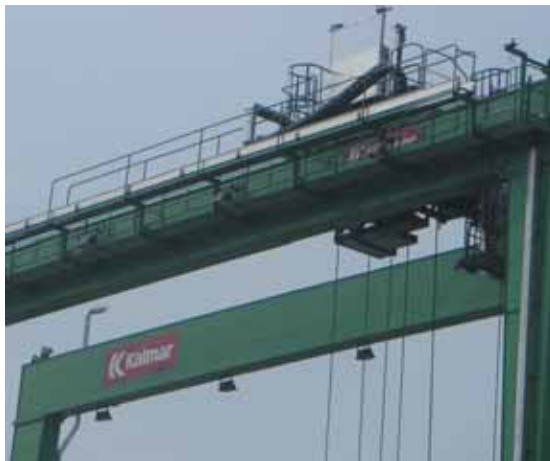
RTG in India, Travel: 22 m, E-Chain®: 5050.30.550.0, Customer: Kalmar for ATM RTG in Indien, Verfahrweg: 22 m, E-Kette®: 5050.30.550.0, Kunde: Kalmar, for ATM
