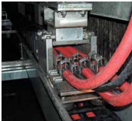
Clamps for safe cable strain relief Bügelschellen zur sicheren Zugentlastung der Leitungen
