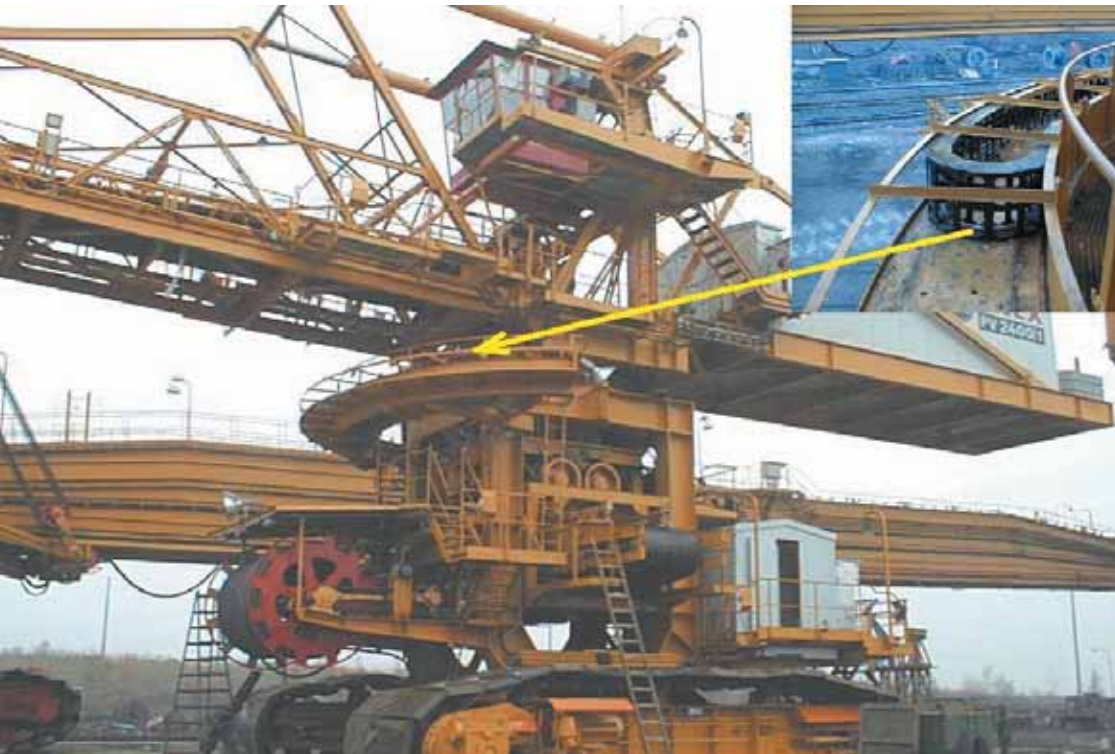
Rotary application on a bucket-wheel excavator using igus® E-ChainSystem® Drehbewegung an einem Schaufelradbagger mit igus® E-KettenSystem®
