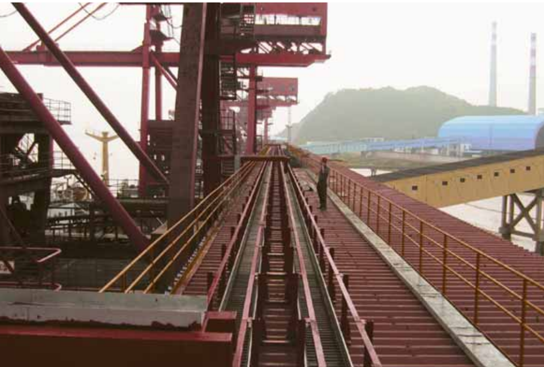
Rol E-ChainSystem® with a 190 m travel length Rollenkettensystem auf 190 m Verfahrweg
