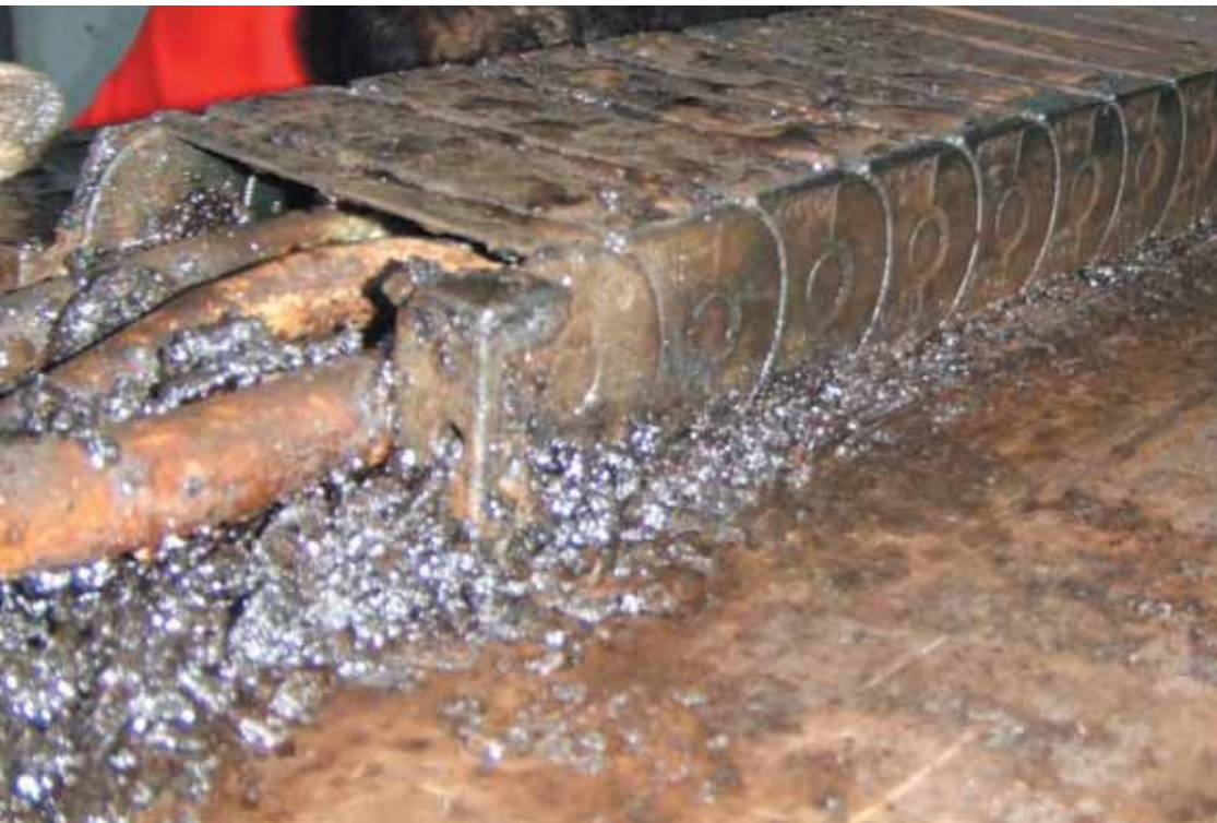
Very high contamination with construction materials Stärkste Verschmutzung durch Straßenbaumaterialien
