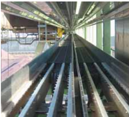
Extension link support for E-Chain- System® with several extension links Mittelbandabstützung für E-Ketten- Systeme® mit Mittelbändern
