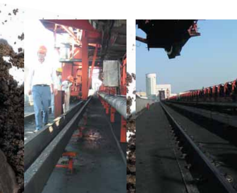
Supply of the bucket-wheel reclaimers using igus® E-Chains® Versorgung des Bucket-Wheel-Reclaimers mit igus® E-Ketten®
