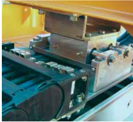
Floating towing arm, to counter misalignment Schwimmender Mitnehmer, zum Ausgleich von Horizontalversätzen
