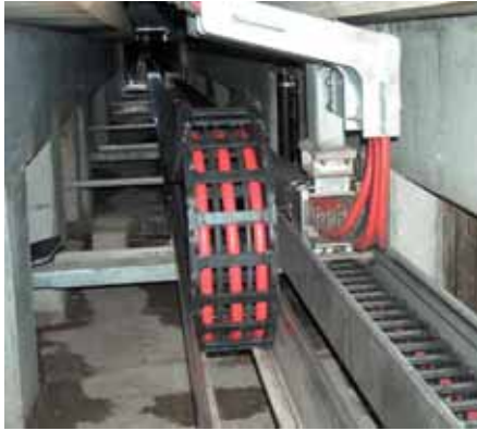
Floating towing arm, to counter misalignment Schwimmender Mitnehmer, zum Ausgleich von Horizontalversätzen
