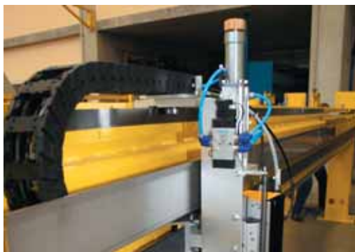
E6 ruckfrei in einem Schneidwerkzeug E6 jerkyless in a cutting tool
