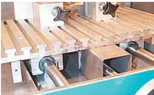
DryLin® R in einer Trennschleifmaschine DryLin® R in a parting-off grinder
