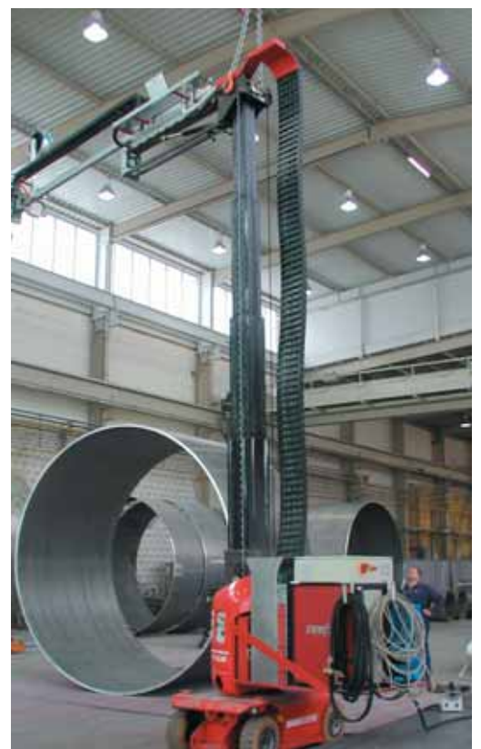
Mobiler Schweißträger mit ReadyChain® Mobile welding carrier with ReadyChain®
