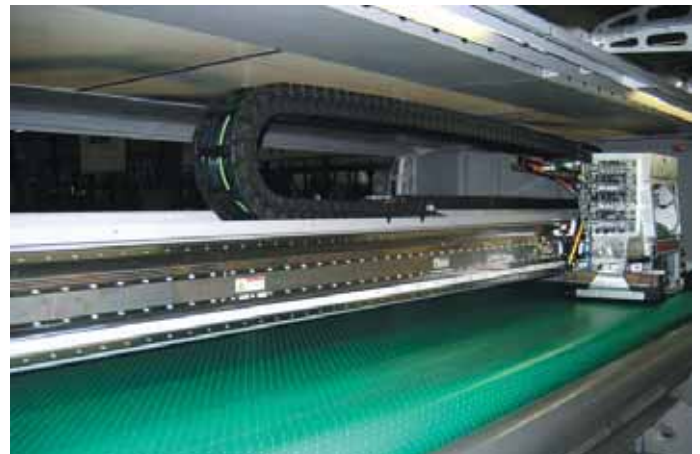
Vibrationsarmes System E6 in einem Großformatdrucker. Low vibration system E6 in a large-format printer.
