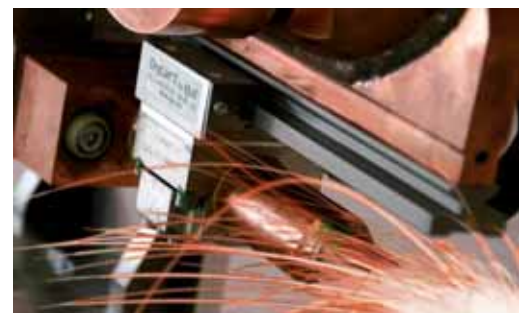
DryLin® T in Schweißzange. 24h Einsatz DryLin® T in welding guns. 24h operation
