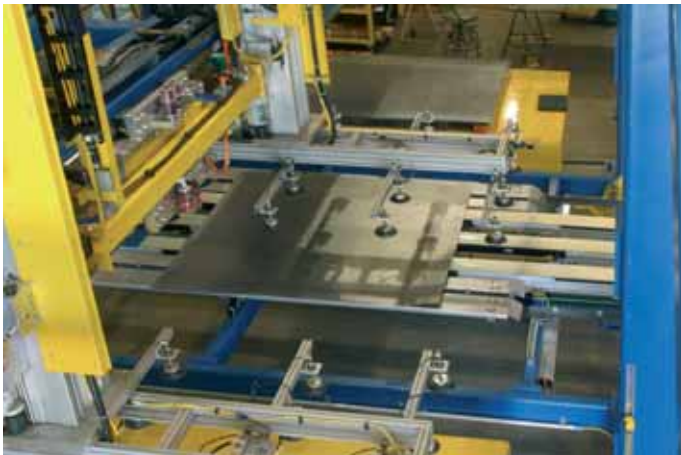
Handhabung von Blechplatten mit dem igus® E6 System Handling of metal blanks with the igus® E6 system
