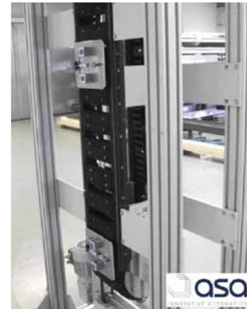
pikchain® als Vertikalförderer für Pappkartons (Firma ASA in Mainhausen) pikchain® as vertical conveyor for cartons (company ASA in Mainhausen)
