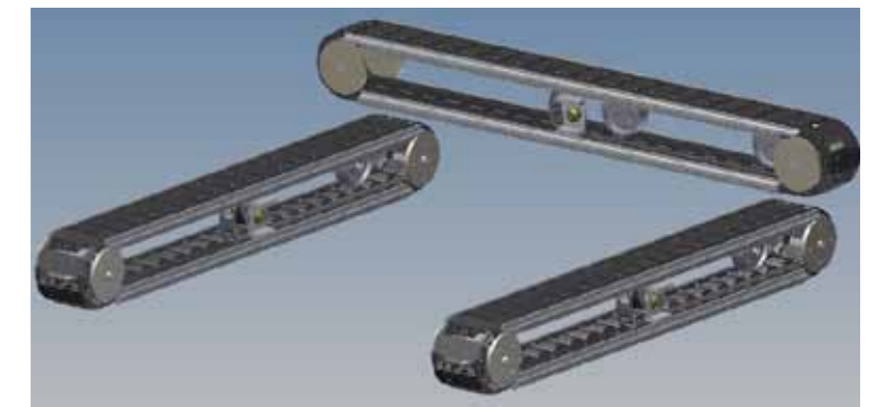
Studie: Drei pikchains® als interaktive Bestandteile einer Analyse- und Sortiermaschine für technische Komponenten Study: Three pikchains® as interactive components of an analysis and sorting machine for technical components
