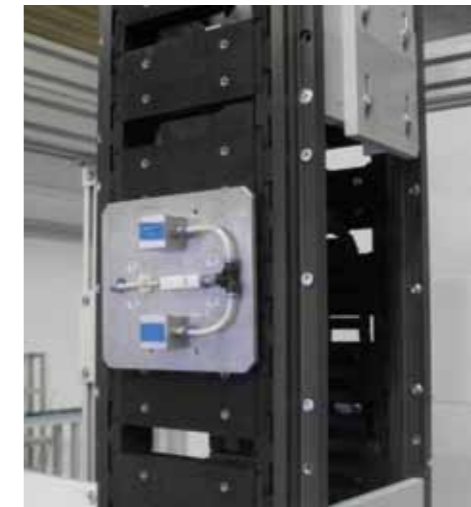
Beispiel einer Adapterplatte für Saugnapfe Example of an adapter plate for vacuum cups
